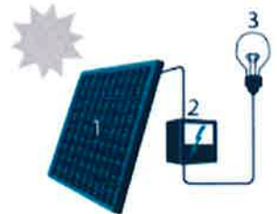
1. Zonnepaneel | 2. Omvormer | 3. Elektrische toestellen
