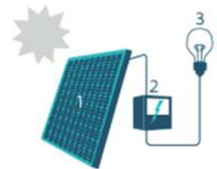
1. Zonnepaneel | 2. Omvormer | 3. Elektrische toestellen
