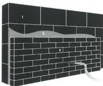
1. Dragende muur | 2. Ingeblazen isolatie | 3. Gevelsteen / gevelbekleding
