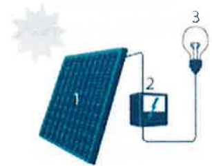
1. Zonnepaneel | 2. Omvormer | 3. Elektrische toestellen
